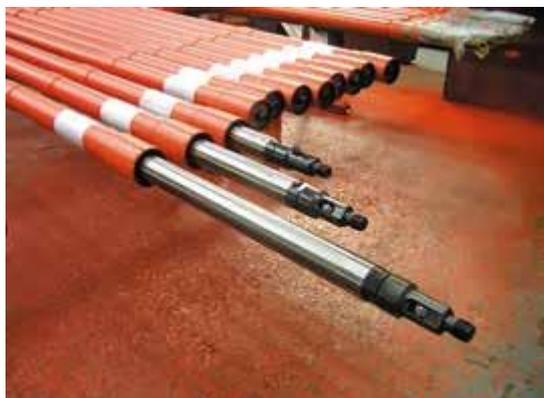
Скважинные штанговые насосы (СШН) поставляются в сборе, а также в виде отдельных узлов и деталей. Основная деталь СШН – цельный толстостенный цилиндр – изготавливается из прецизионной трубы в кооперации с металлургическими и трубными заводами. Рабочая поверхность цилиндра подвергается глубокому азотированию (толщина слоя 0,2...0,5 мм, твердость 870–1124 HV) либо гальваническому хромированию (толщина слоя 0,08 мм, микротвердость 700...900 HV).
